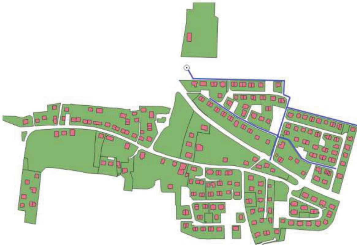
Abbildung 8-17: Mögliche Heizwerkposition und Verlauf Wärmenetz Oberroth Nord
