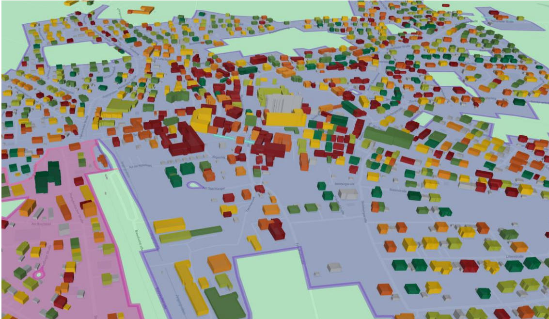
Abbildung 1: Exemplarischer Screenshot aus der 3D-Darstellung des Digitalen Zwillings aus dem ENEKA-Energieplaner; Färbung entspricht Wärmebedarfsdichte, Ort: Altomünster
